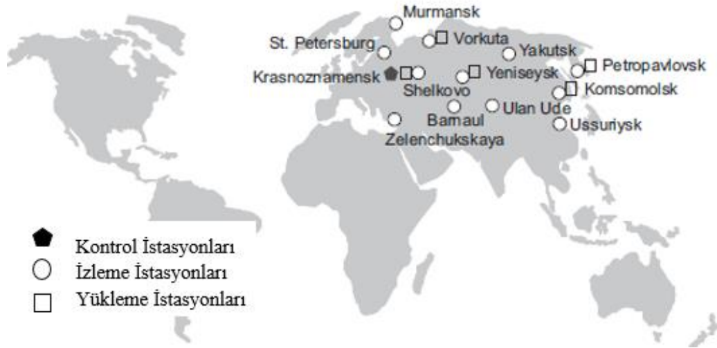
Şekil 2.5. GLONASS uydu sisteminin kontrol, izleme ve yükleme istasyonları (Bahatta, 2021).
