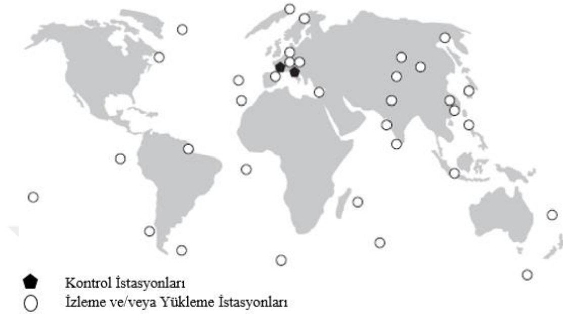
Şekil 2.8. Galileo uydu sisteminin kontrol, izleme/yükleme istasyonları (Bahatta, 2021).
