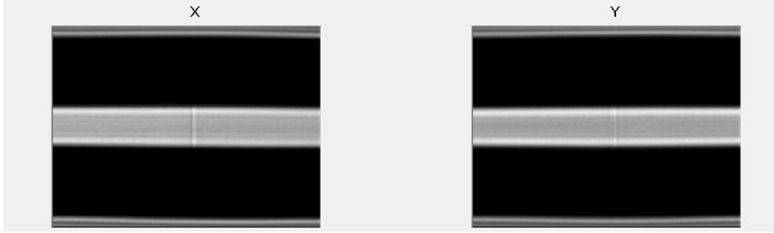
Şekil 3.6: Diyod ve Fiber birleştirici (Combiner) fiber kaynak görüntüsü (Splice 1,8).
