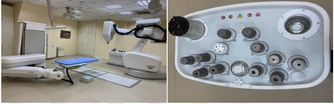
Şekil 7. Cyberknife cihazı ve tedavide kullanılan konlar
