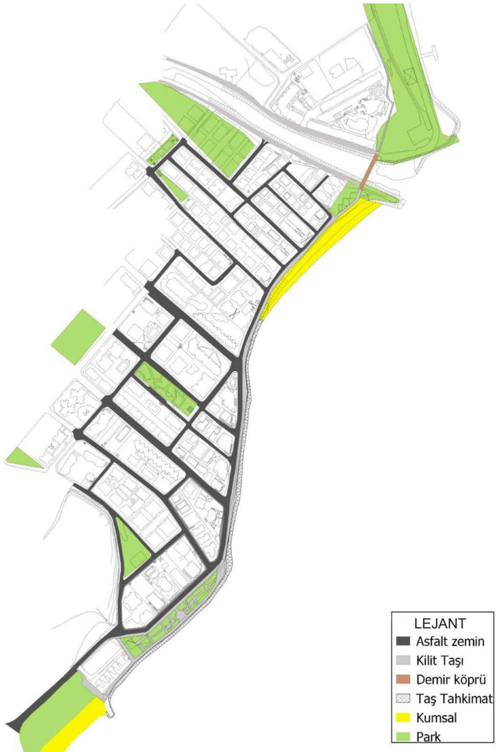
Şekil 6.14. Kıyı Alanında Yapılan Projelerde Belirlenen Zemin Malzemeleri
