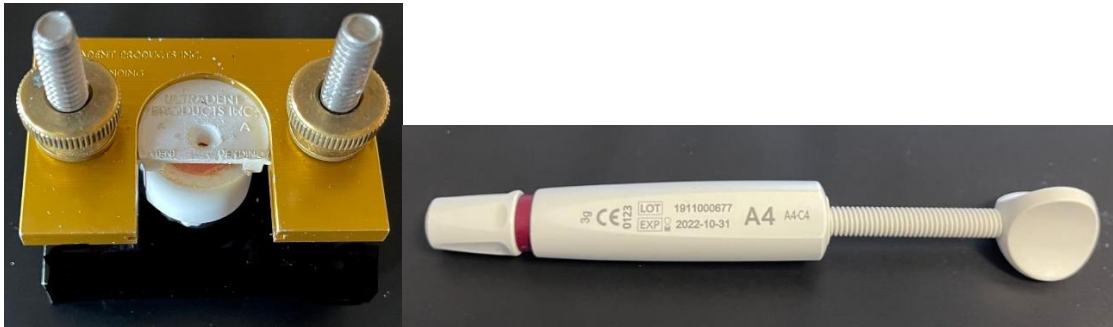
Şekil 3.8. Dentin yüzeylerine kompozit yerleştirilmesini sağlayan aparat ve kompozit rezin olarak kullanılan ceram.x® SphereTEC™ one.
