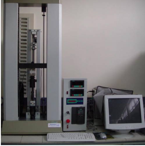
Şekil 3.10. Makaslama bağlanma dayanımı testi için kullanılan universal test cihazı (Marestek, Türkiye).
