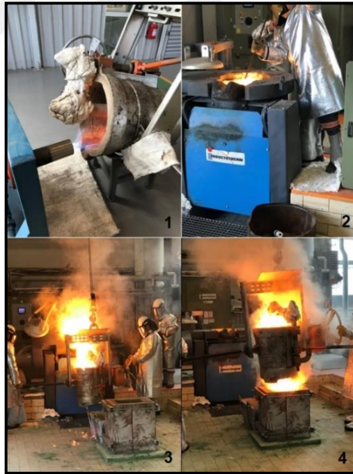
Şekil 5.53 Ergitme ve döküm işleminde operasyon adımları: Döküm işlemi öncesi potanın ısıtmaya alınması (1); Açık indüksiyon fırınında ergitme ve alaşımlama işlemleri (2); Sıvı metalin transfer potasına alınması (3); Transfer potasından metal kokil kalıba döküm besleme işlemi (4)
