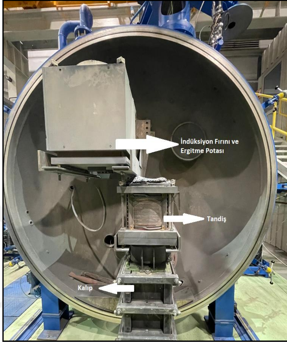
Şekil 5.58 Vakum indüksiyon fırını iç hazne bölümü
