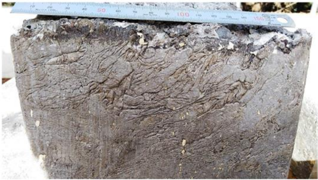
Şekil 6.6 6 numaralı alaşımda ingot dökümde oluşan bifilm yüzeyleri
