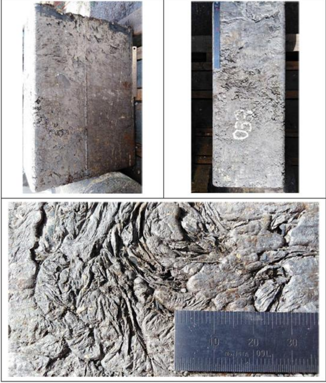
Şekil 6.5 5 numaralı alaşımda ingot dökümde oluşan bifilm yüzeyleri
