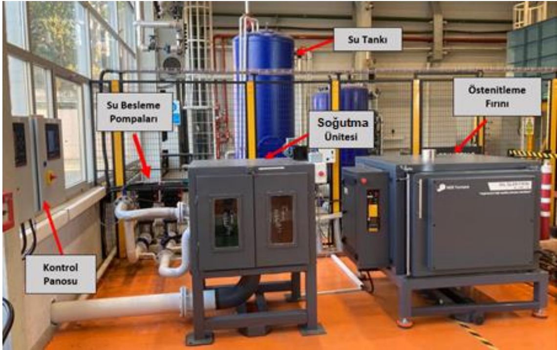
Şekil 5.72 Isıl işlem fırını ve soğutma (quench) sistemi
