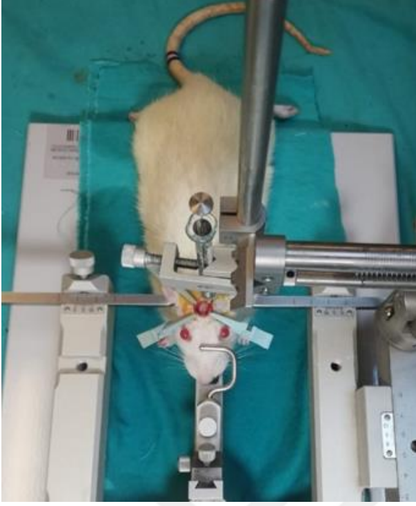
Resim 3.2. Ratın stereotaksi cihazına yerleştirilmesi, üstten görünüm
