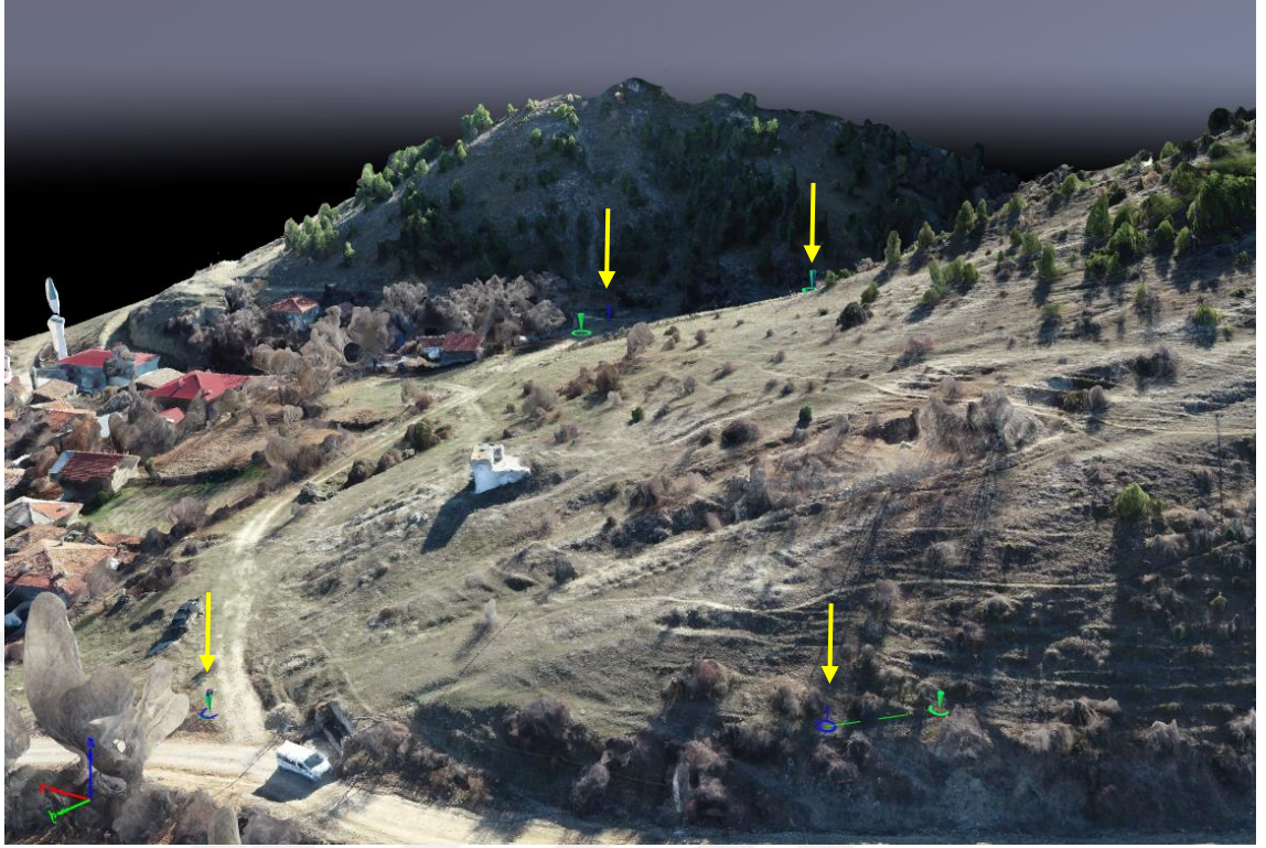
Şekil 3.8 Çalışma alanına ait YKN ve Pix4D yazılımı ve elde edilen arazi modeli
