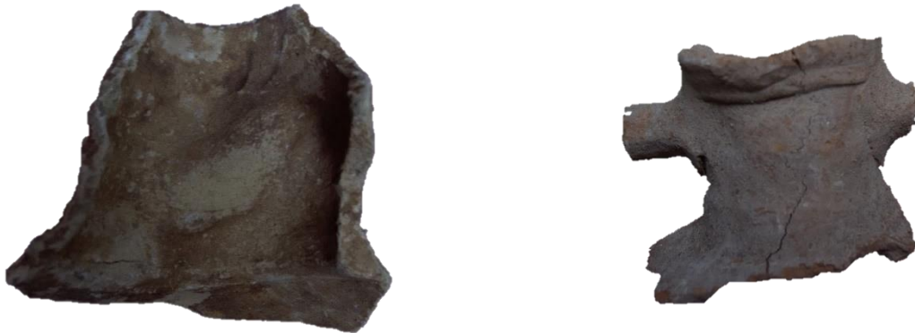
Resim 3.3: Üretim hatalı LR-1 örnekleri
