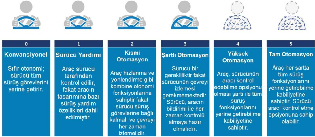
Şekil 1.2. SAE Otonomi Seviyeleri (Başargan, 2019).
