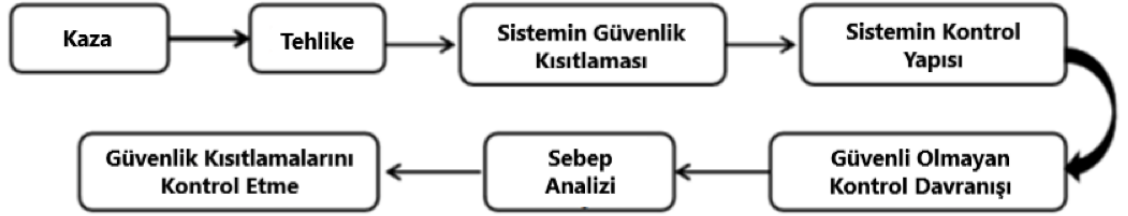
Şekil 3.15. STPA Metodunun Uygulama Akış Diyagramı (Hu, 2020).
