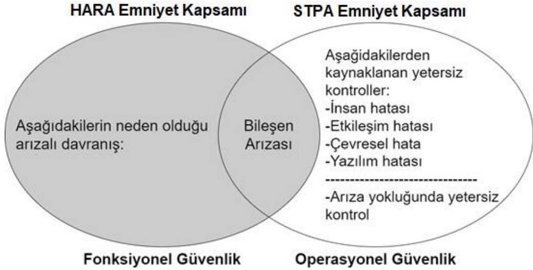
Şekil 3.14. 1703.03657 STPA ve ISO 26262 Kapsamlarının Karşılaştırılması (Abdulkhaleg vd, 2017).
