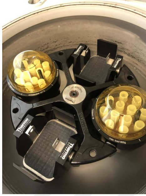
Şekil 3.6. Simetrik şekilde ayarlanan santrifüj makinesi
