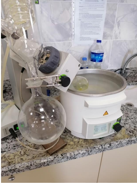
Şekil 4.17. Rotary evaportörde pigmentlerin kurutulması
