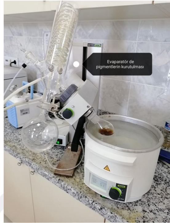
Şekil 4.17. Rotary evaportörde pigmentlerin kurutulması
