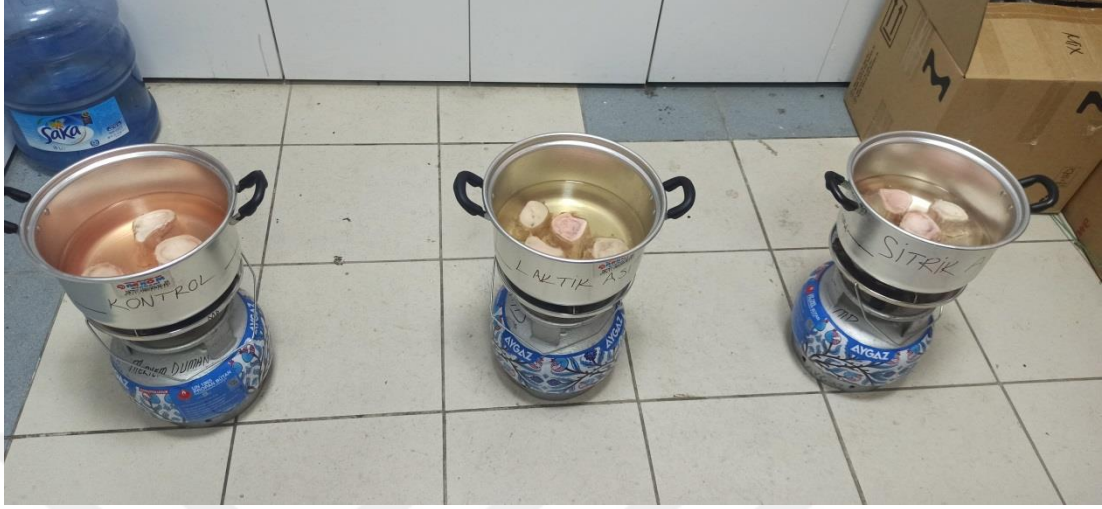
(Ek-4) Açık Kazan Yöntemiyle Kontrol, Sitrik Asitli ve Laktik Asitli Numunelerin Üretimi
