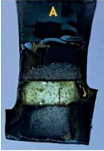
Resim 3. 2. Kronoamperometre sonrası dışarı alınan elektrot üzerinde ki sarı sıvı
