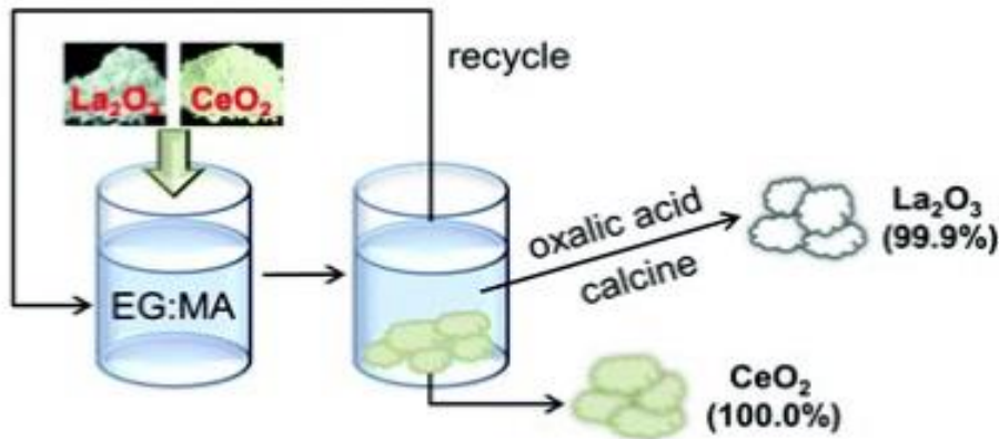
Şekil 3.26. Saf (%99.99) La 2 O 3 ve Ce 2 O 3 tamamen çözecek DES geliştirip, DES içine salınan ve iyon formda olan seryum ve lantan sisteme katılan oksalik asit ve 700 °C kalsine ile tekrar La 2 O 3 ve Ce 2 O 3 dönüştürülmesi
