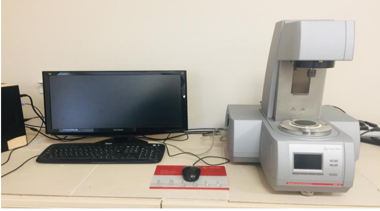
Resim 2. 2. Anton Paar MCR 301 marka reometre cihazı
