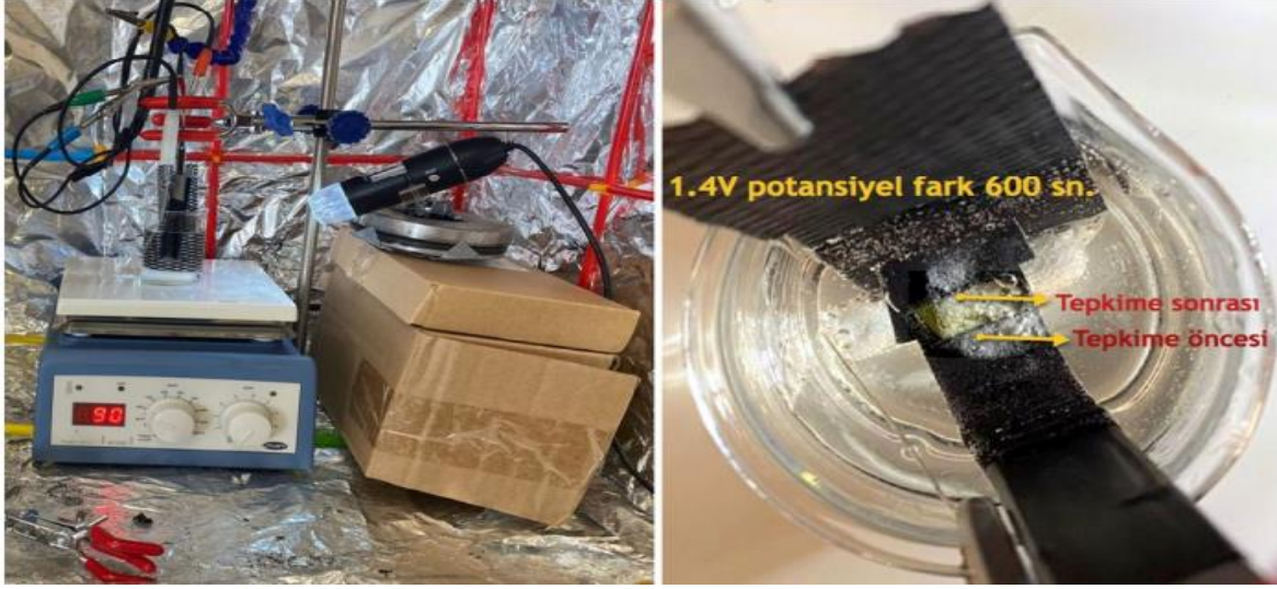
Resim 3. 1. L şeklindeki yumuşak çelik elektrot ve üzerinde gerçekleştirilen deney
