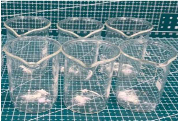
Resim 3. 4. 50 mL’lik her bir beher içerisinde 0,02 gram NTE karbonat tozlarının katılması
