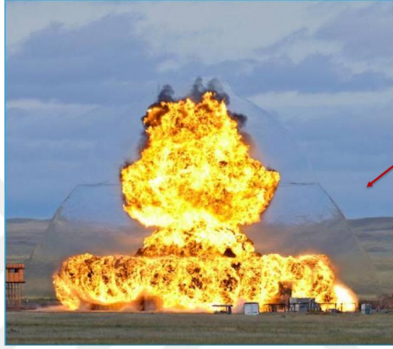
Şekil 26. Buhar Bulutu Patlaması (DNV Test Sahası)
