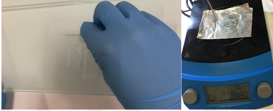
Şekil 3.74 FTO cam üzerine TiO 2 'nin kaplama işlemi
