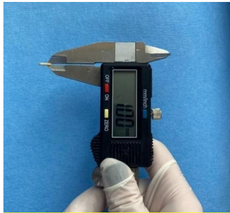
Şekil 3. 4. Kesitlerin kalınlığının dijital kumpas ile ölçülmesi
