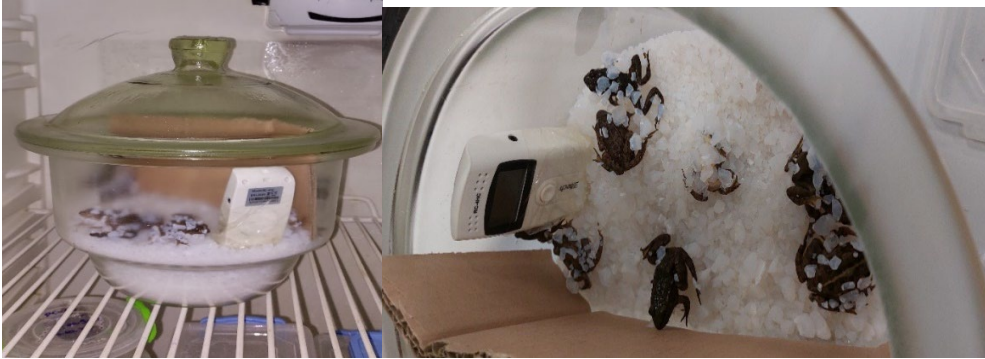
Resim 3.7 Dehidrasyon stresi için hazırlık ve devamında dehidrasyon stresinin başlatılması.
