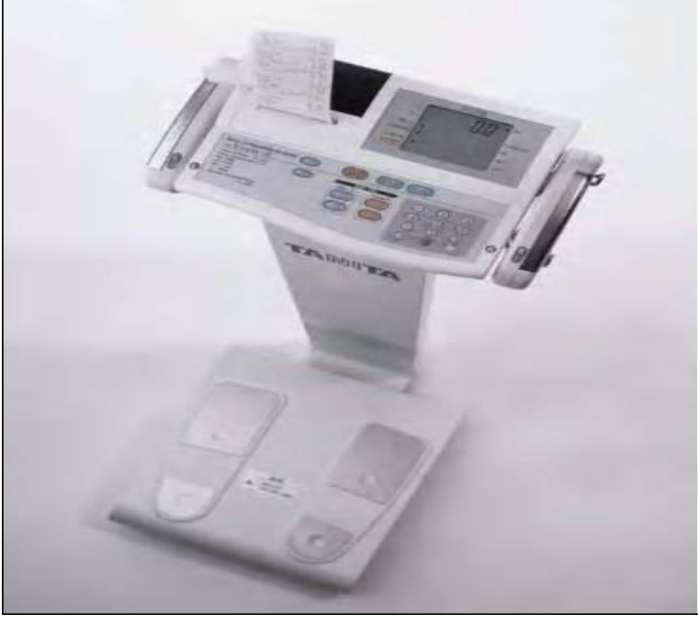
Şekil 3.2. Biyoelektrik İmpedans Analizi (BİA) Ölçüm Cihazı.
