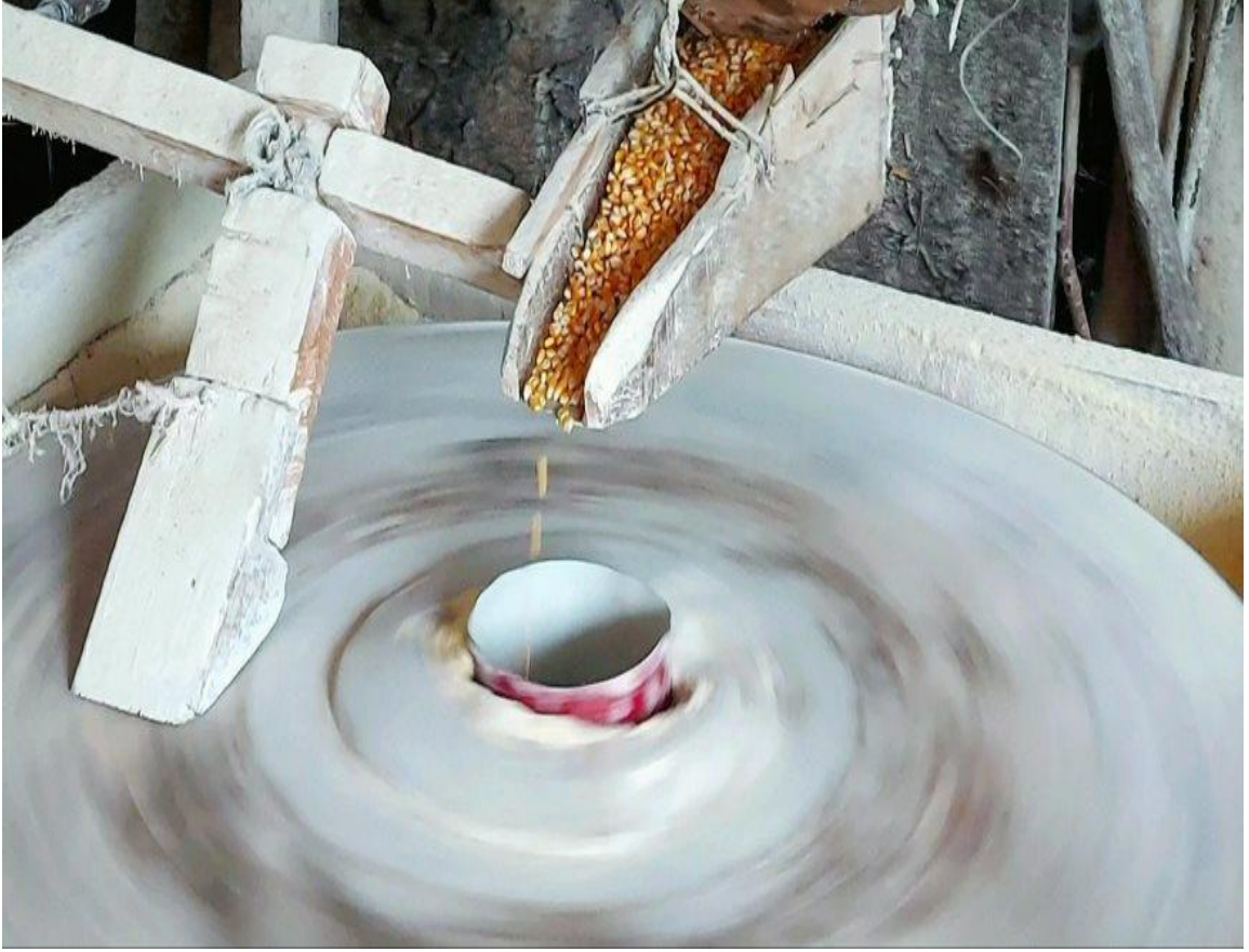
Şekil 7. Kaşıktaki mısır tanelerinin boğaz bölümünden değirmen taşının kanalına düşmesi.
