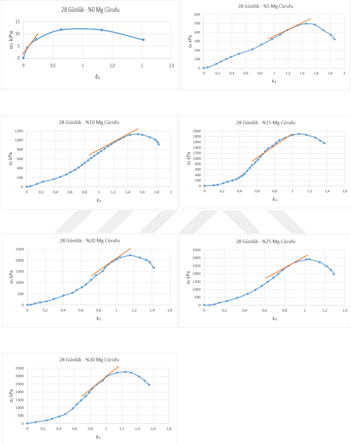
Şekil EK2.3 28 günlük numunelerin elastisite modüllerinin belirlenmesi.
