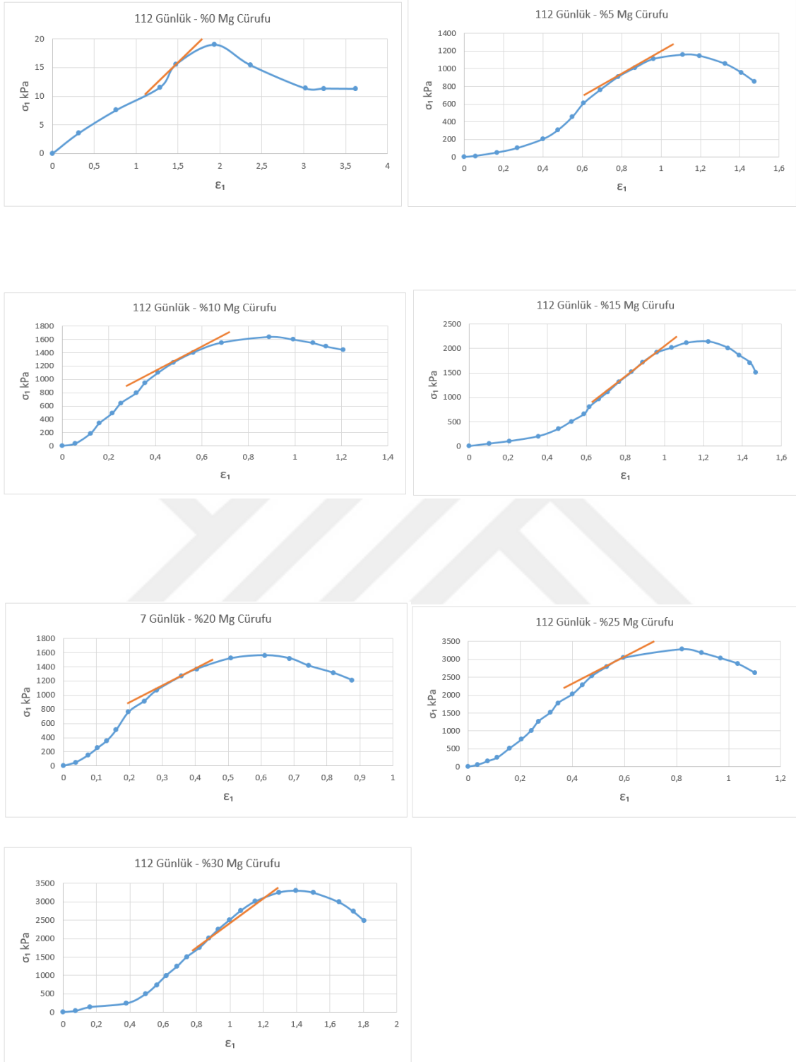
Şekil EK2.5 112 günlük numunelerin elastisite modüllerinin belirlenmesi.
