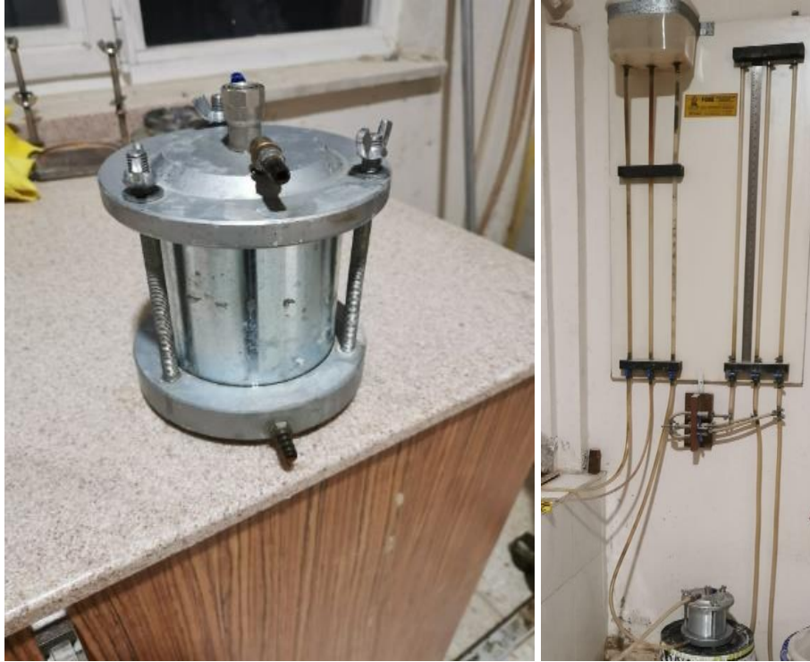
Resim 3.11 Permeabilite deney hücresi ve sistemi.
