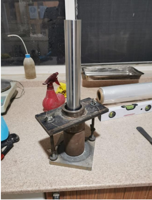
Resim 3.6 Tek eksenli basınç deneyi numune hazırlama.
