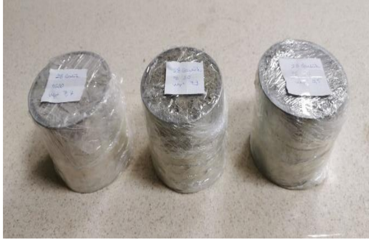
Resim 3.10 Permeabilite deneyi numuneler.
