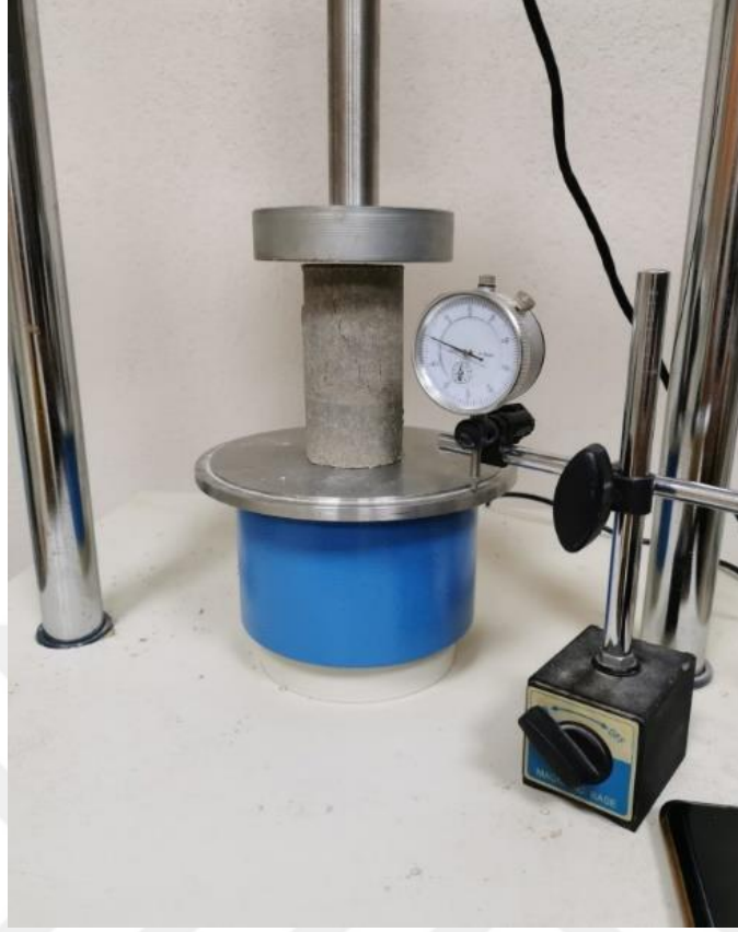
Resim 3.8 Serbest basınç deneyi aletine numunenin yerleştirilip kırılması.
