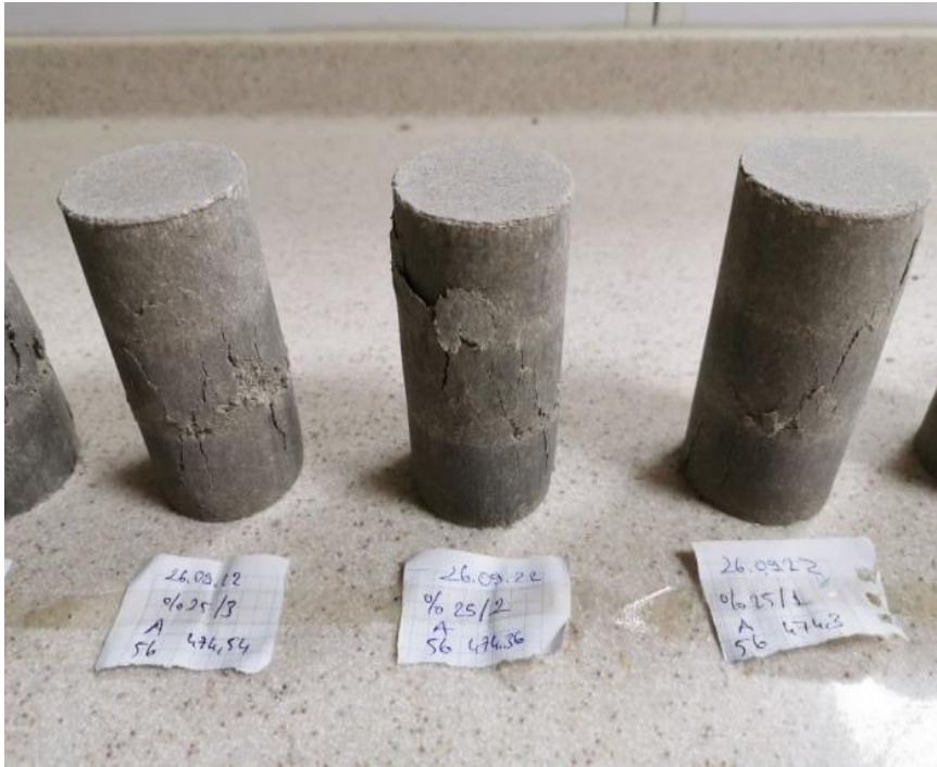
Resim 3.9 Serbest basınç deneyi sonundaski numuneler.
