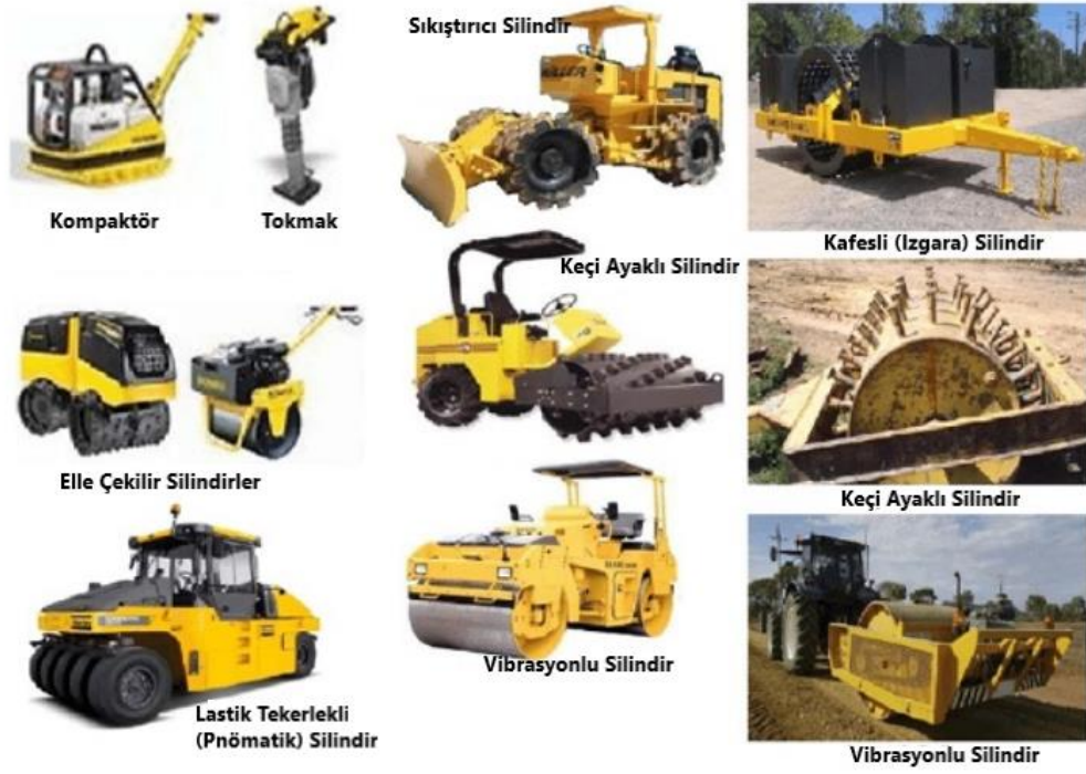
Resim 2.1 Kompaksiyon ile zemin iyileştirme yöntemi alet ve ekipmanları (İnt. Kayn. 1).
