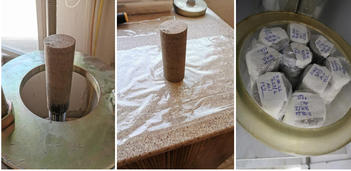
Resim 3.7 Numunenin çıkarılması, sarılması ve saklanması.
