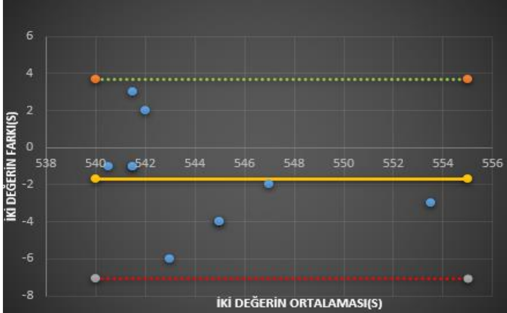
Şekil 4.7 Bitermal kalorik test düzeneği 44 derece sıcaklık değerinin 3900 ml sıvı seviyesi için otomatik olarak hazırlanma süresinin Fluke Marka 724 model sıcaklık kalibratörü ile karşılaştırılmalı Bland Altman Grafikleri.
