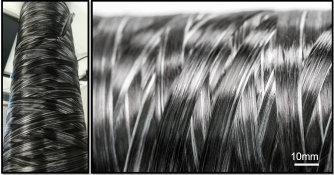
Şekil 3.4: Karbon fiber takviyeli PPS ve PA6 matrisli hibrit fiberler.
