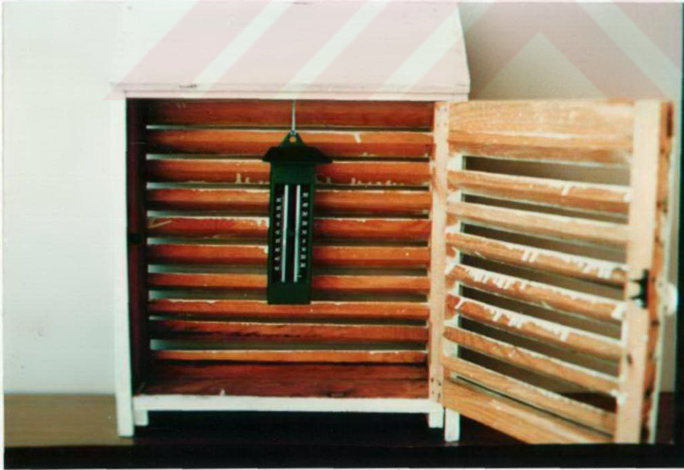
Şekil 1. Hava Sıcaklık ölçümlerinde kullanılan max.-min. termometre ve kabini.
