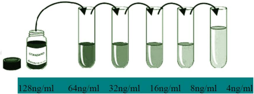
Şekil 3.6. Standart çözeltilere ait dilüsyonların hazırlanması.
