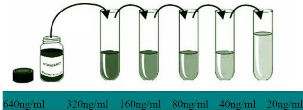
Şekil 3.5. Standart çözeltilere ait dilüsyonların hazırlanması.
