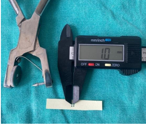
Resim 3.14. Lastik örtü delik açıcısı, post-it üzerine açılmış delikler
