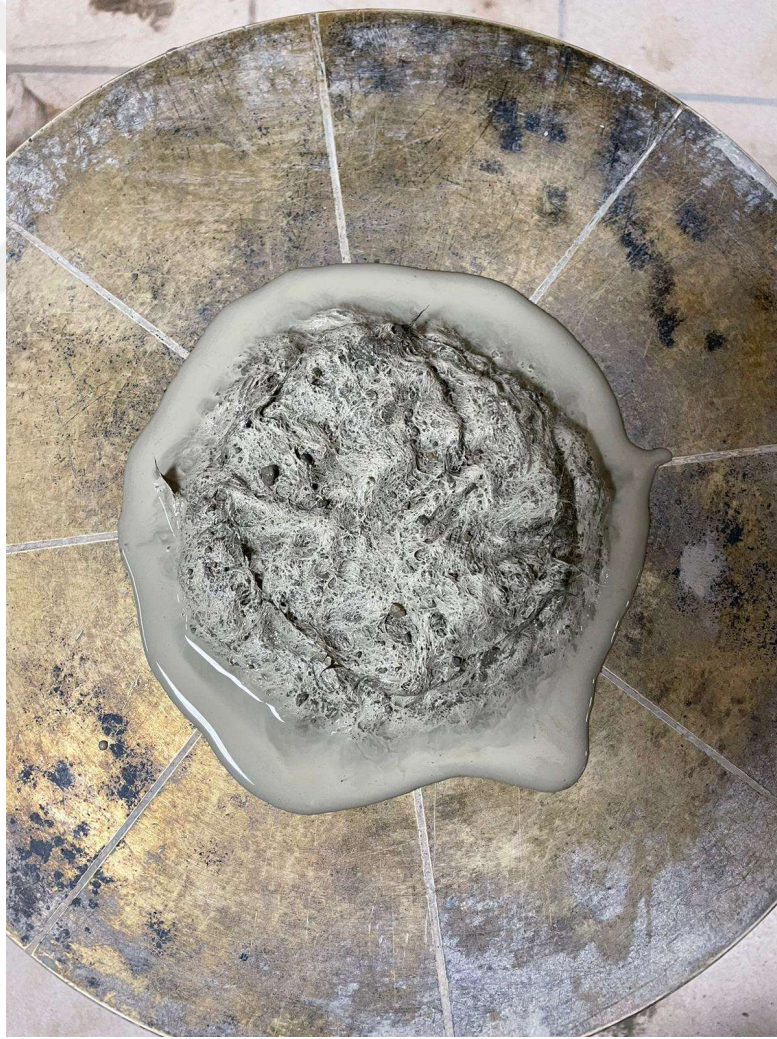
Şekil 4.7. Bataklık oluşumu gözlenmiş bir harç numunesi (K35-4)
