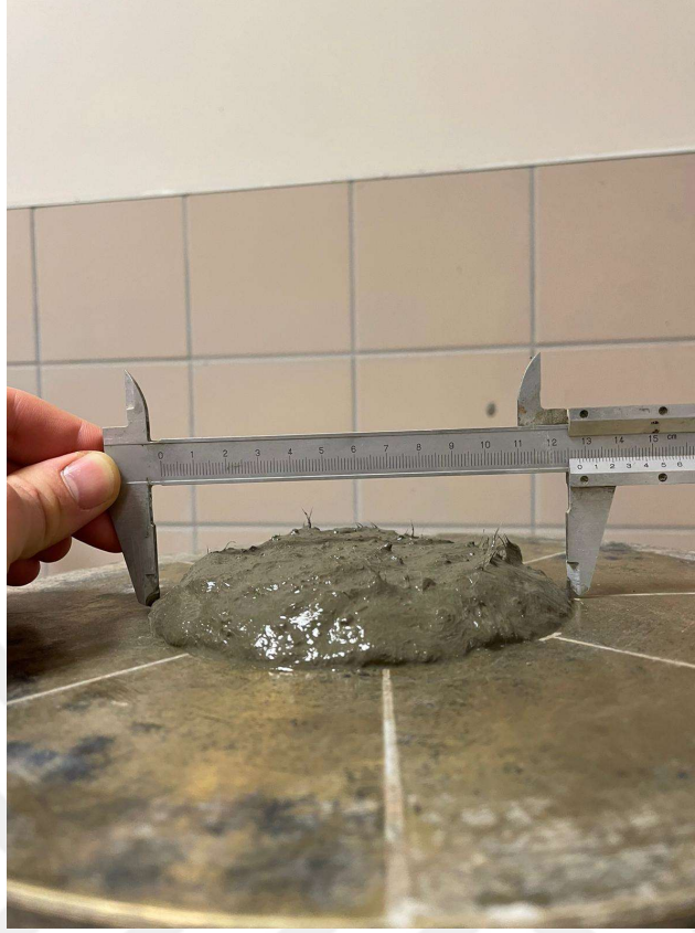
Şekil 3.4. Numunenin yayılma çapının ölçülmesi
