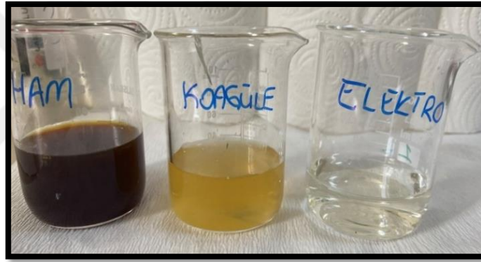
Şekil 4.39: Ham atık su-kimyasal arıtım çıkışı ve grafit anot ile EO çıkışı atık sudaki değişim.
