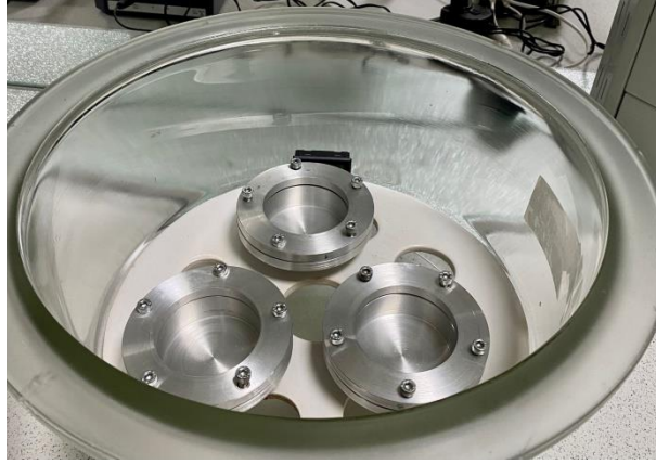
Şekil 6. Su buharı geçirgenliği analizinde kullanılan dairesel alüminyum test kapları.
