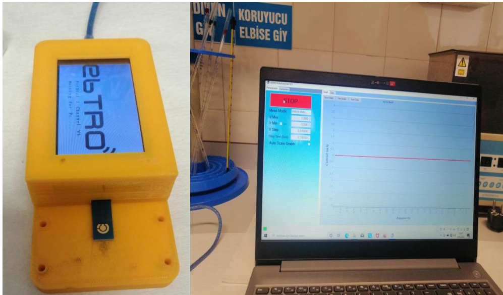
Şekil 8: Devirli Voltmetri Cihazı Ve EBTRO Potansiyostat Programı
