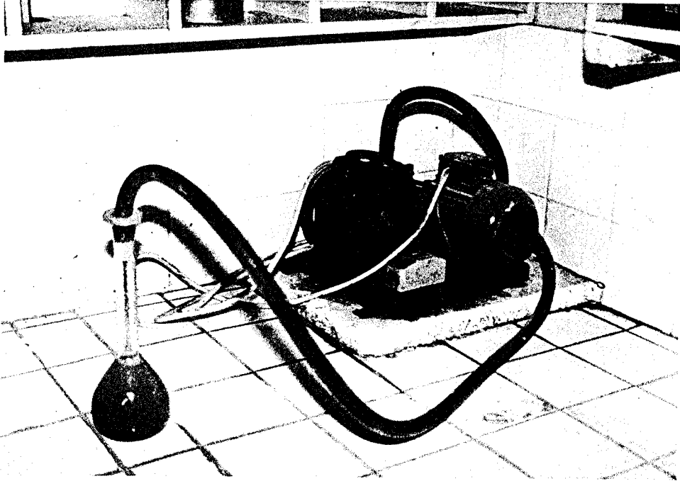
Şekil 3.11b. Özgöl ağırlık tayininde kullanılan deney düzeneği (Vakum Pompası)
