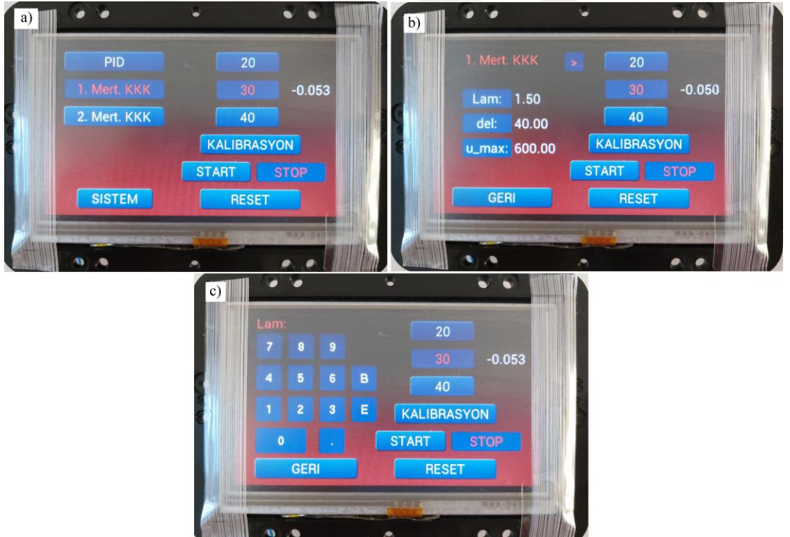
Şekil 3.9. Arayüz sayfaları: a) Ana ekran b) Parametre sayfası c) Değer atama sayfası
