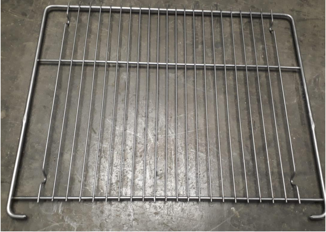
Fotoğraf 3.3. Direnç nokta kaynağı ile birleştirilmiş bir fırın iç ızgarası
