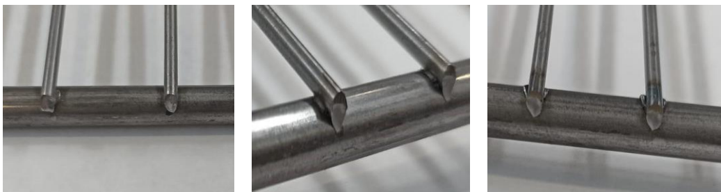
Fotoğraf 4.2. CuCoBe elektrodu kullanılarak a) 8 kA ve 8 ms b) 9 kA ve 12 ms c) 12 kA ve 16 ms kaynak parametreleri ile yapılan kaynağın kaynaklı ürün fotoğrafı
