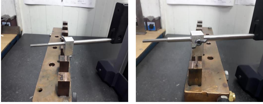
Fotoğraf 4.7. CuCoBe ve CuNi 3 Si elektrotları üzerinden 15000 kaynak sonrası oluşan deformasyonun (iz derinliği) mihengir yardımı ile ölçülmesi
