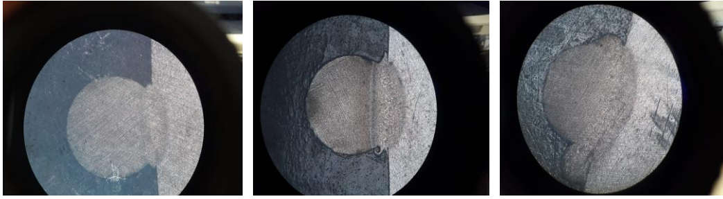
Fotoğraf 4.1. CuCoBe elektrodu kullanılarak a) 8 kA ve 8 ms b) 9 kA ve 12 ms c) 12 kA ve 16 ms kaynak parametreleri ile yapılan kaynağın 50 büyütmedeki kaynak çekirdeği fotoğrafı
