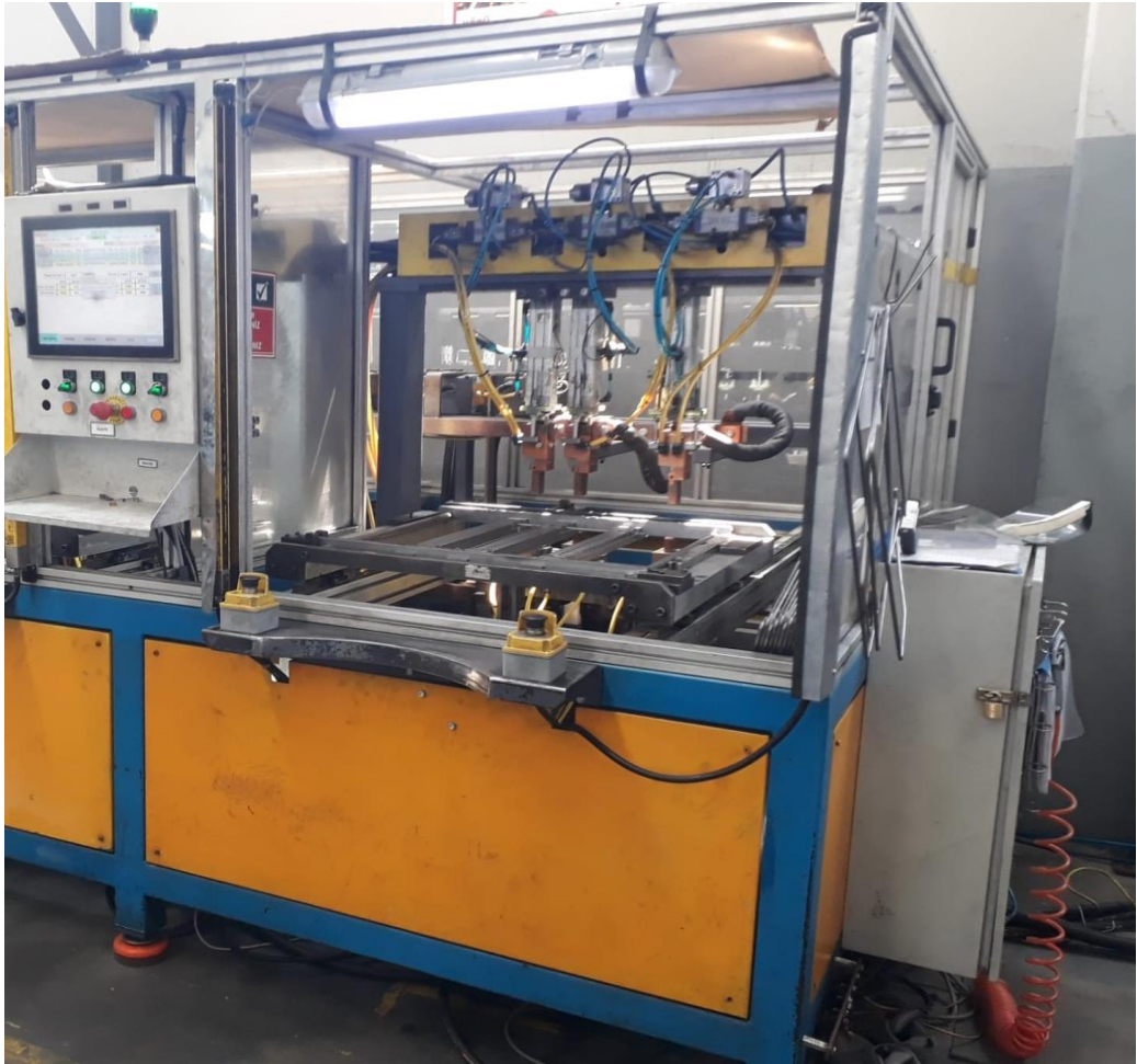
Fotoğraf 3.1. Kaynak çalışmalarında kullanılan direnç punta kaynak makinesi
