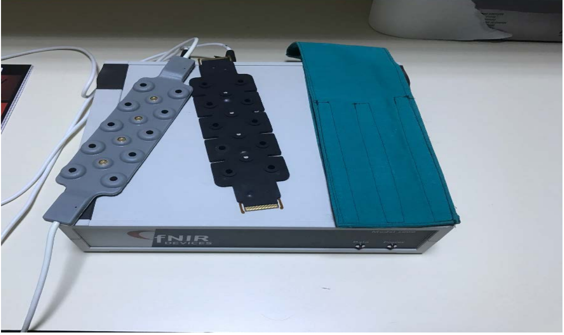
Şekil 10. 16 Kanallı Optotlar ve fNIRS Cihazı
