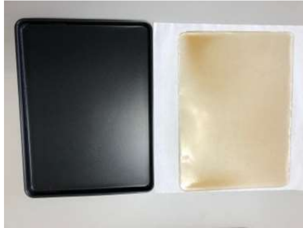
Şekil 3.7. Teflon tepside kurutularak paketlemeye uygun formda elde edilen film örneği.
