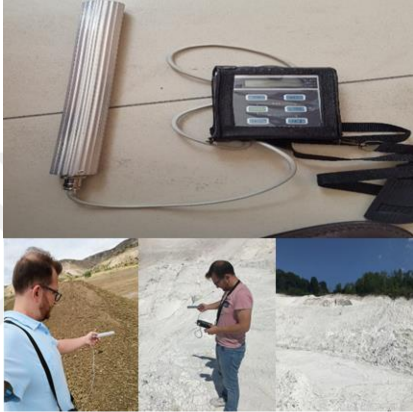
Fotoğraf 2.6 Gama doz hızlarının ölçülmesi
