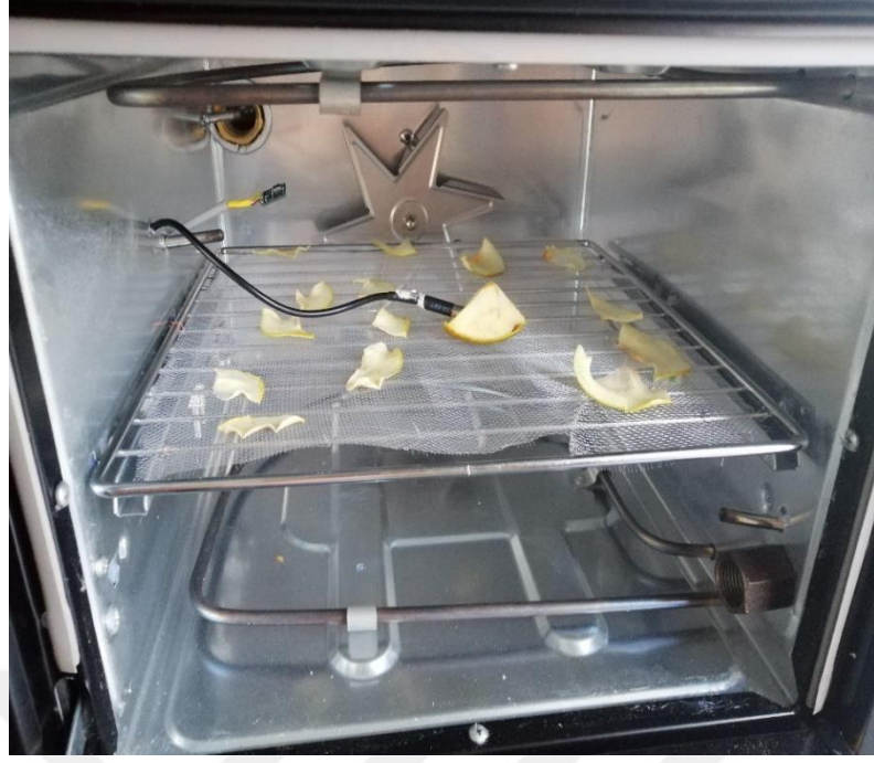
Şekil C.7. Tasarımı yapılan sistemde kurutucu kabin içi
