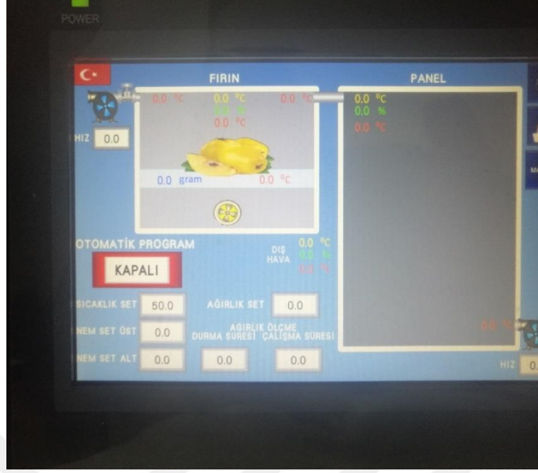
Şekil C.9. Kurutma kontrol sistemi ekranı
