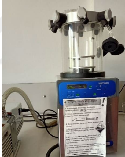
Şekil 3.9. Santrifüjlenen örneklerin liyofilizatör ile kurutulması.
