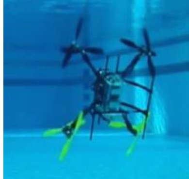
Sekil 1.14: Bir Ortamdan Diğeriine Geçebilen İlk Prototip Araç.
