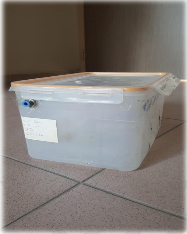
Şekil 3.3. Karbondioksit uygulamasında kullanılan gaz sızdırmaz kabin
