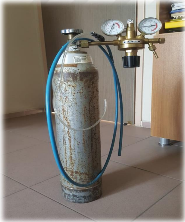
Şekil 3.4. Karbondioksit uygulamasında kullanılan CO 2 tüpü
