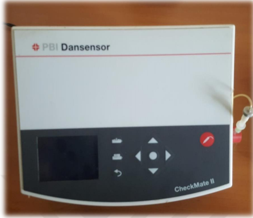
Şekil 3.5. Karbondioksit uygulamasında kullanılan gaz kontrol cihazı
