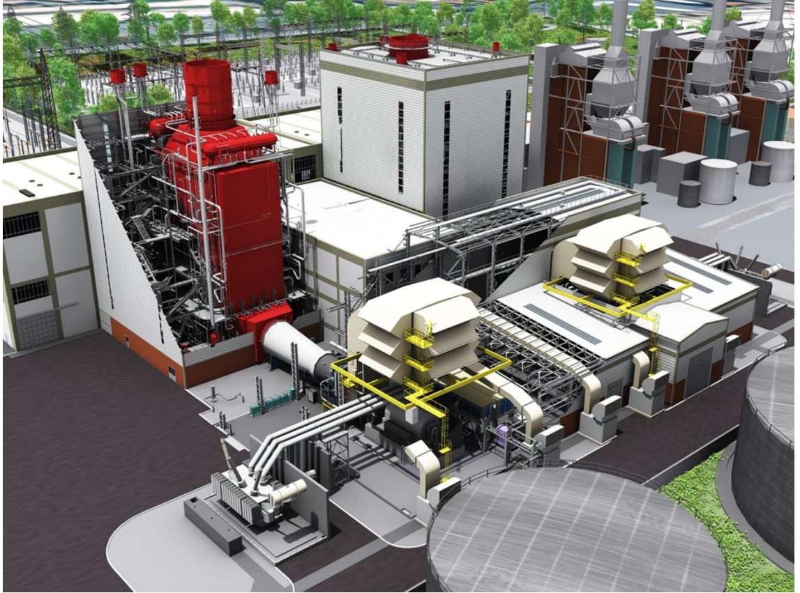
Şekil 2.23 İstanbul Doğal Gaz Kombine Çevrim B Santrali atık ısı kazanının üç boyutlu modeli
