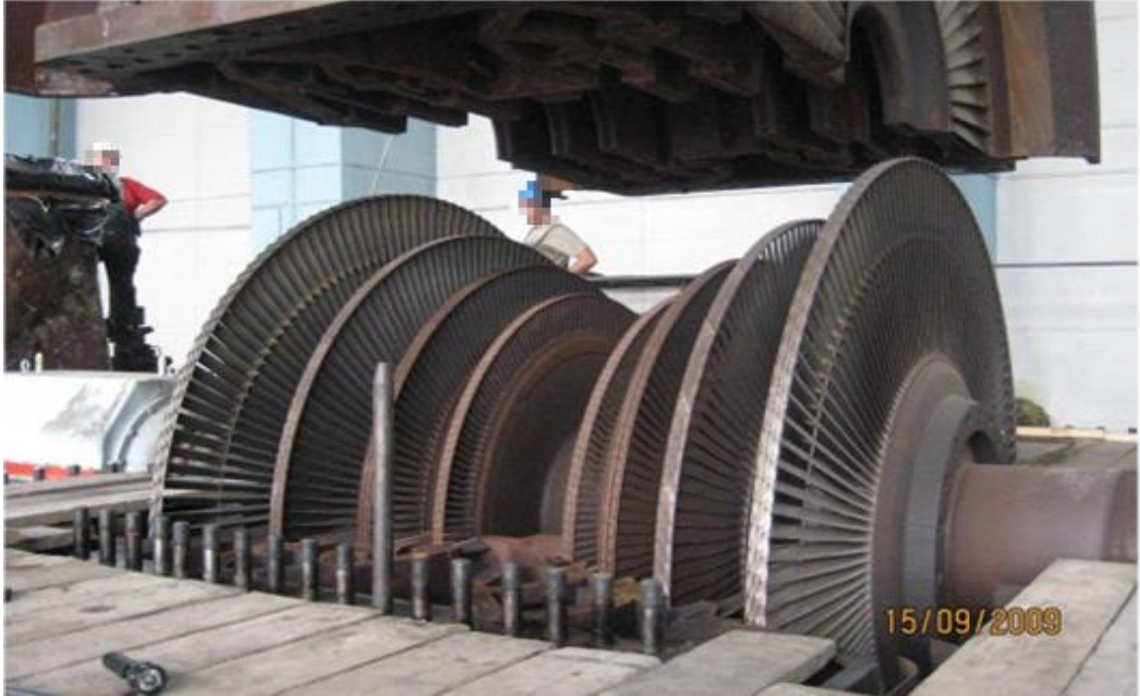
Şekil 2.24 İstanbul Doğal Gaz Kombine Çevrim B Santrali'nde bulunan buhar türbinin alçak basınç kademesi
