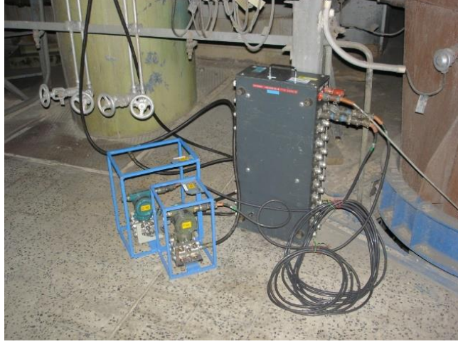
Şekil 3.10 Proses ve veri kaydedici arasında bağlanan basınç transmitterleri
