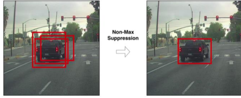
Şekil 2.40 Maksimum olmayı önleme (non-maximum suppression) [46]
