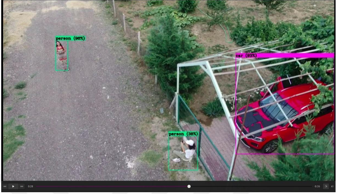
Şekil 3.23 Yeniden eğitim sonrası oluşan ağırlıkların video üzerinde test edilmesi
