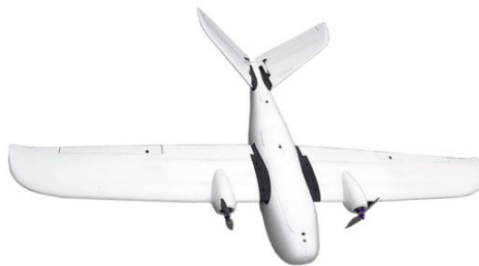
Şekil 1.2 Sabit kanatlı insansız hava aracı [3]
