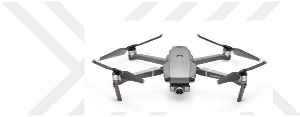
Şekil 1.1 Döner kanatlı insansız hava aracı [2]
