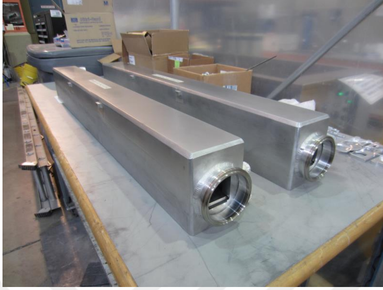
Şekil 2.8. Ariel Elektron demeti durdurucusu (Nozar, 2014).
