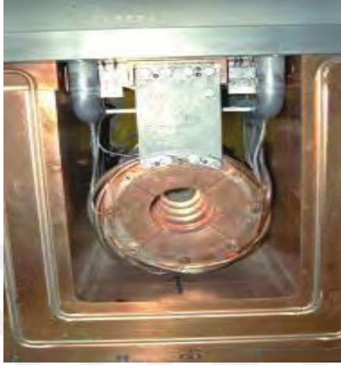
Şekil 2.4. PSI proton demet durdurucusu (Reggiani, 2012).
