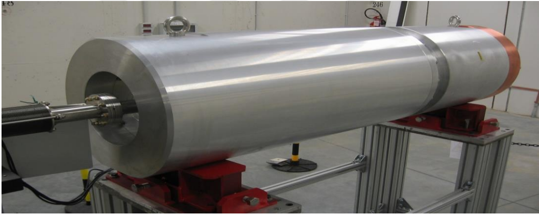
Şekil 2.6. FERMI elektron demet durdurucusu (Frohlich et.al, 2014).
