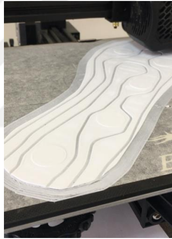
Şekil 3.2: Ayakkabı tabanının 3D Yazıcı ile üretilme aşaması.
