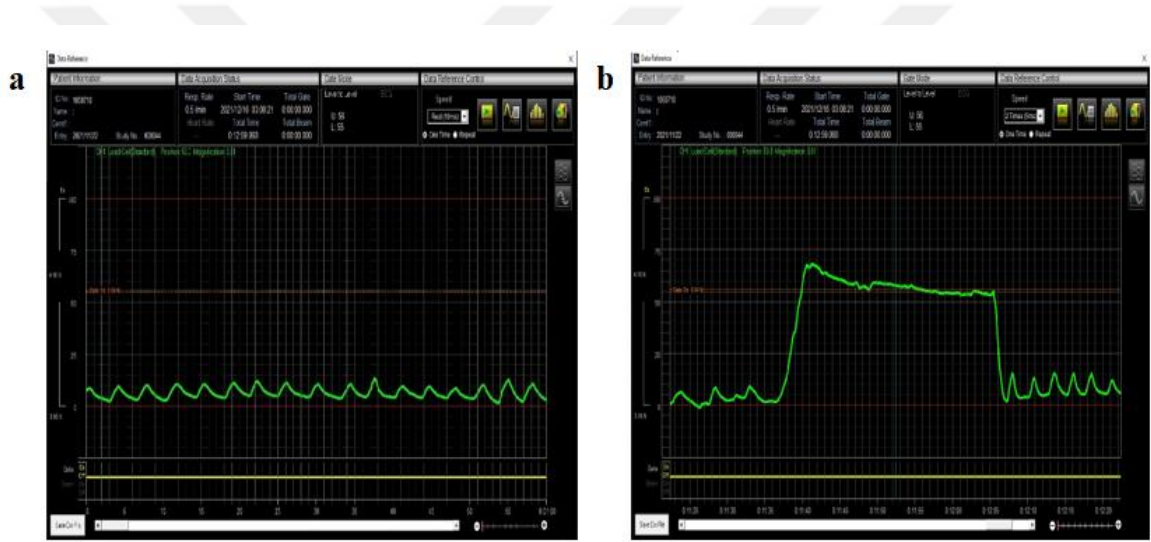
Şekil 7. Hasta solunumunun dalga formu şeklinde görüntüsü. (a) FB solunum takip görüntüsü. (b) BH solunum takip görüntüsü.
