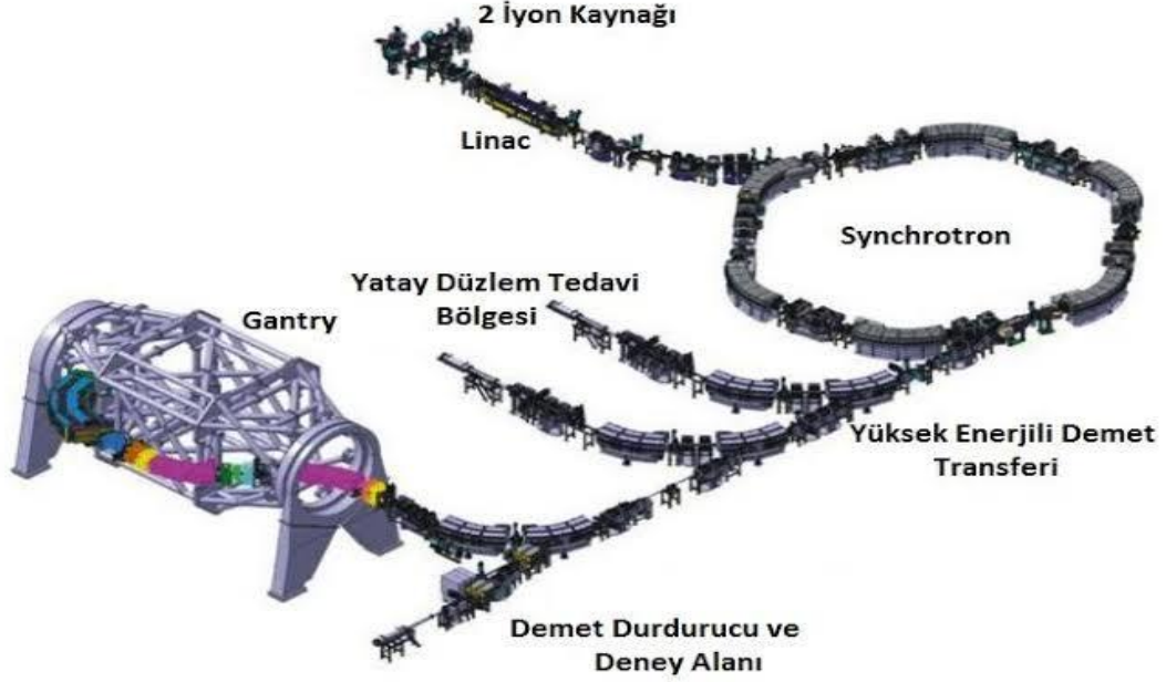
Şekil 12. Ağır İyon Tıp Merkezi tesisini gösteren şema.
