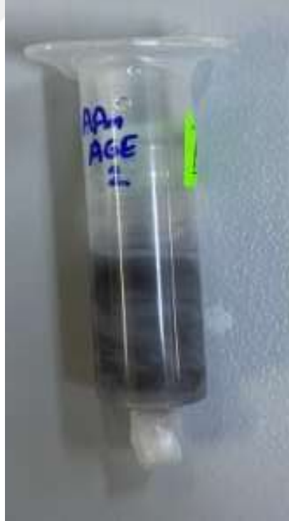
Resim 3.2. Tirozinaz enzimi bağlı, tirozin substratı geçirilmiş ve temizlenemeyen kriyojel
