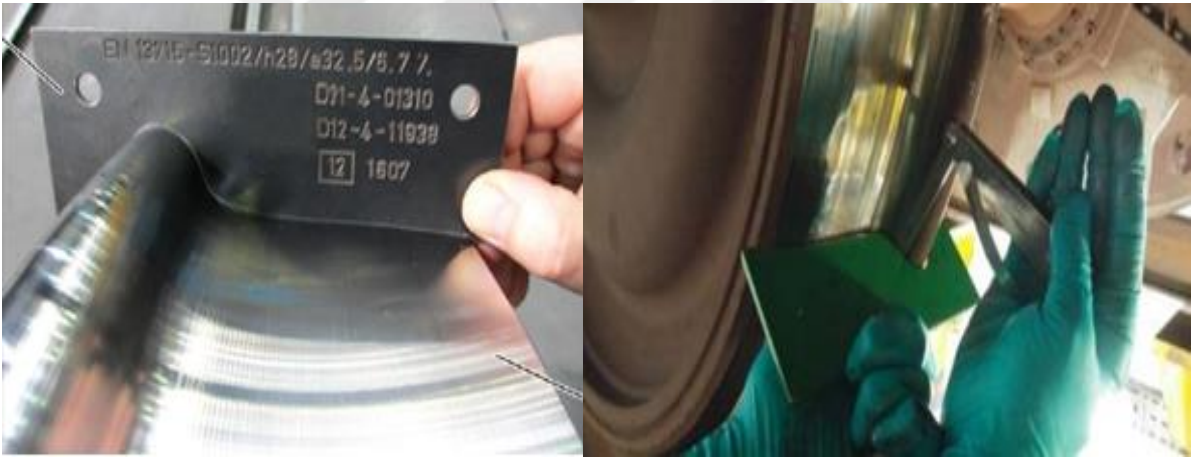
Şekil 3.2: S1002 Tekerlek Profili
