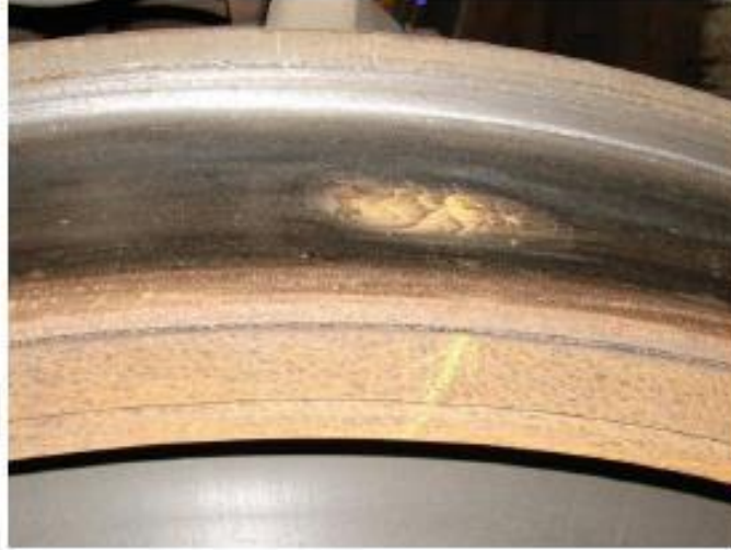
Şekil 3.1: Apleti Olmuş Tekerlek
