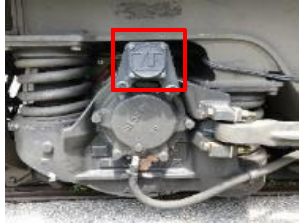
Şekil 3.7: Hattaki Titreşimleri Algılayan Kablosuz Sensör
