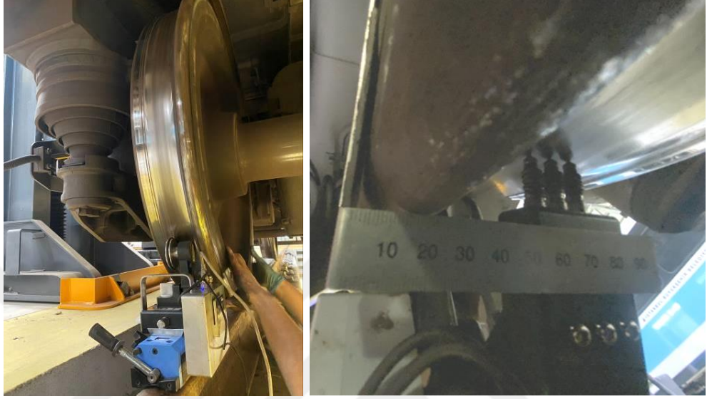
Şekil 4.19: Tekerlek Ölçüm TriTops SN 120907005 montajı ve sensör pozisyonları
