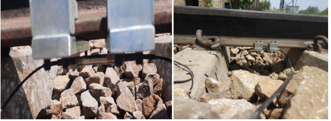
Şekil 2.6: FBG Sensörlerinin Raya Montajı [13]
