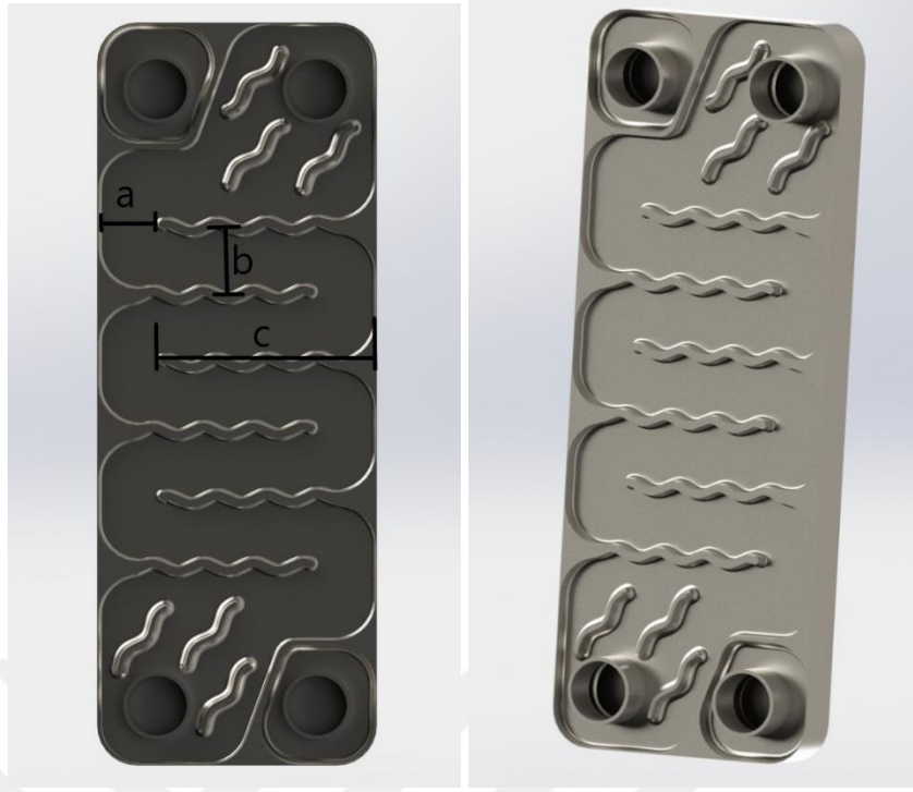
Şekil 3.6. Sinüsoidal akış dağılımına sahip ÖKPİD
