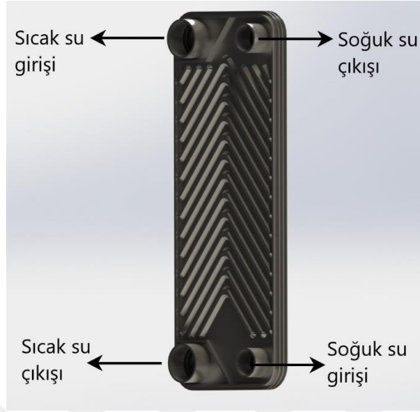
Şekil 3.3. KPID’de akışkan giriş-çıkış yönleri
