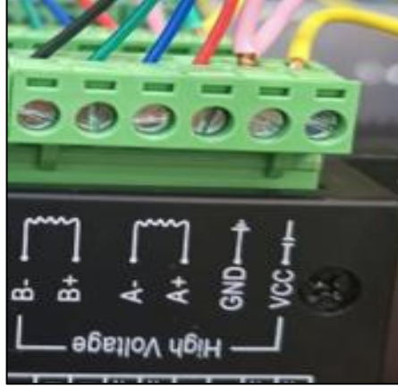
Şekil 3.3. Step motor uçlarının bağlantısı
